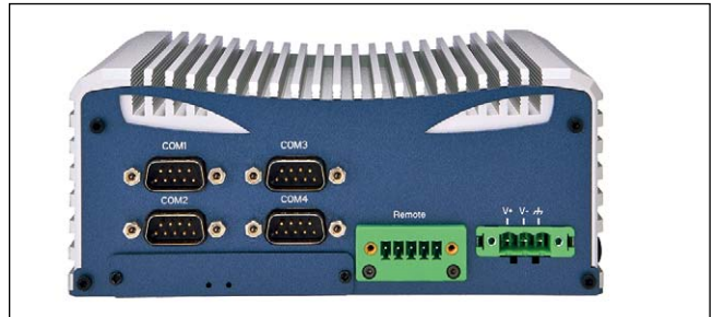
Der AIM ist der kleinste Vertreter der Eagle-Eyes-IPC-Familie von EFCO. Die größeren bieten mehr Schnittstellen und eine höhere Rechenleistung sowie gekühlte Steckplätze für Hochleistungs-Grafikkarten. (EFCO Electronics)
